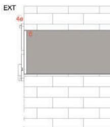
Inserire il diametro di centraggio dell'attacco a parete (4e) all'interno del tubo da incasso (6)
